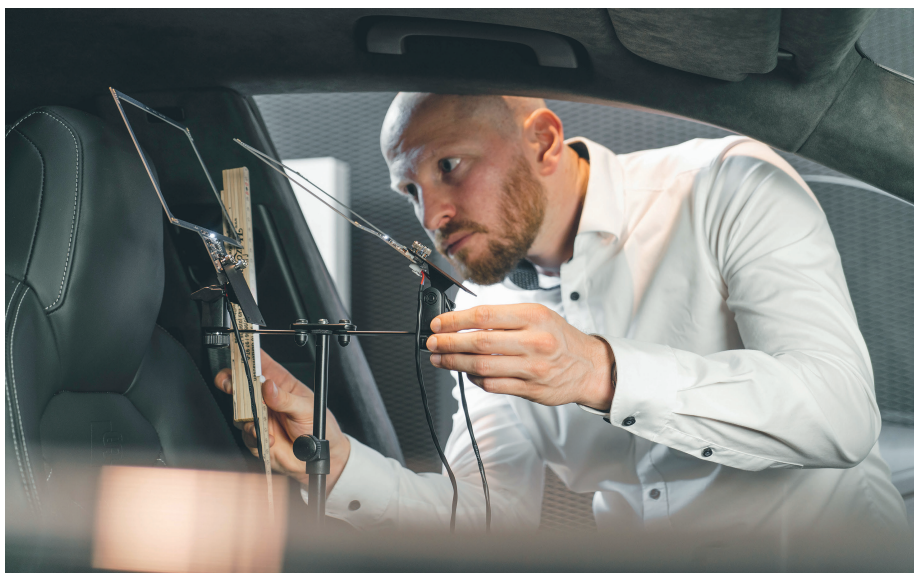
Bild 1: Die Positionierung der Mikrofone spielt bei den Messungen im Fahrzeug eine wichtige Rolle. © EDAG Group
