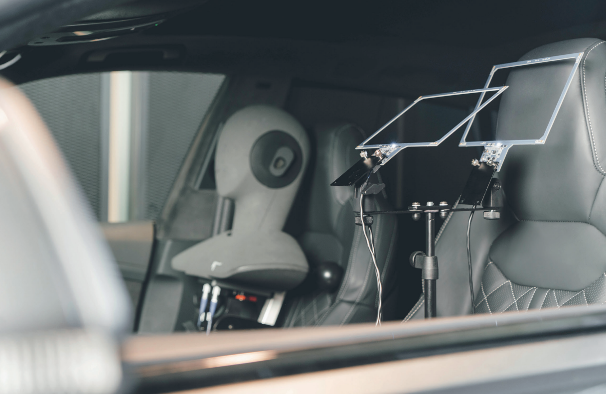
MEMS (Micro Electro Mechanical System) Mikrofonarray (rechts) und Kunstkopf im Hintergrund
